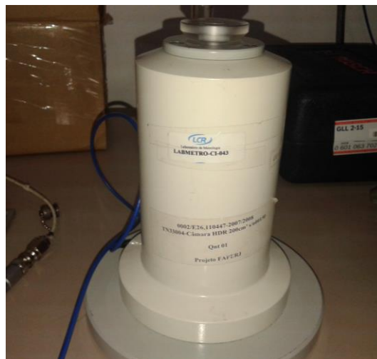
Figura 2 – Foto câmara poço modelo TN33004 da PTW.
