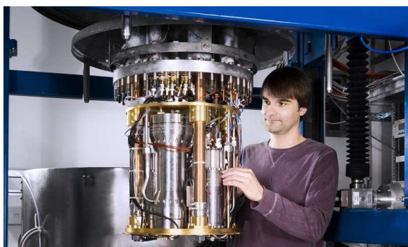
Parte principal do termômetro a gás de constante dielétrica do PTB
