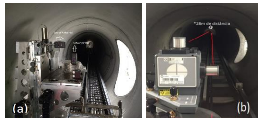
Figura 3. Montagem do setup utilizando Hamar Laser. (a) Posição sensores PSD e (b) cabeçote emissor dos planos de laser.
